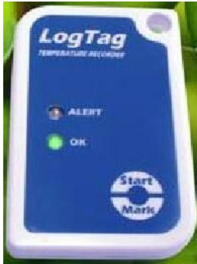
**緑ランプの点灯のときは包装内の試薬が適正温度の範囲内で輸送されていたため評価実験に使用することができます。**
